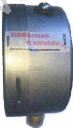
Рисунок 11 – Заводская пломбировка с помощью наклейки
